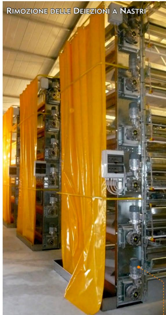
Il Motoriduttore, **UNO PER OGNI NASTRO**, è direttamente inserito sull'albero di traino.
