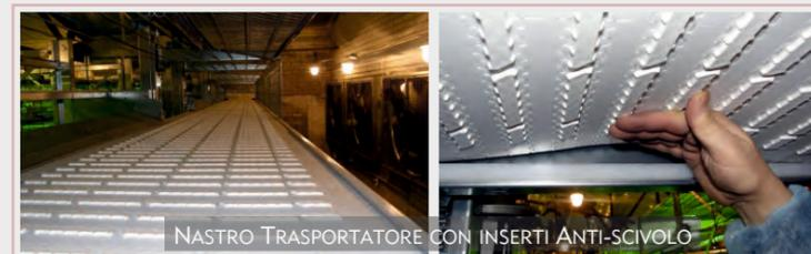
NASTRO TRASPORTATORE CON INSERTE ANTI-SCIVOLO
