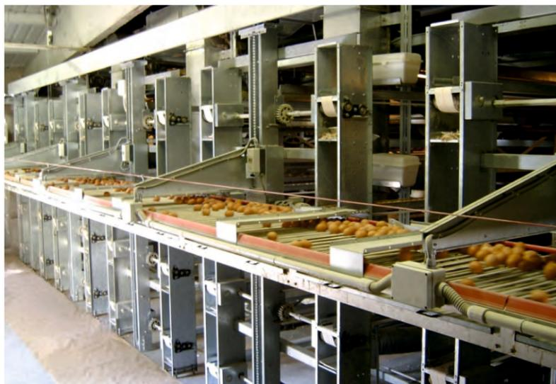
Un motoriduttore da Kw 0.2, in testa ad ogni fila di gabbie muovendosi su e giù solidale con il convogliatore, si ingrana ad una ruota dentata ad ogni piano azionando quindi il movimento della coppia di nastri relativi al piano stesso ad una velocità standard di circa 3.5 m/min..
