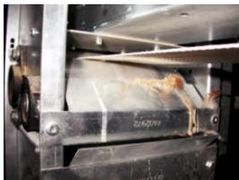
3. Pulizia dei nastri: la superficie del nastro che trasporta le uova viene pulita da apposito raschietto posto in tutti i supporti nastro in corrispondenza di ogni montante di spalla, durante il percorso di ritorno del nastro stesso.
