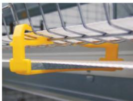
2. Nastri di raccolta uova - disponibili da 100 o 140 mm. larghi: quelli standard sono in tessuto di polipropilene. Il polipropilene rinforzato è indicato per sistemi di attrezzature molto lunghe. I nastri non sono sensibili alle variazioni di temperatura o umidità.
